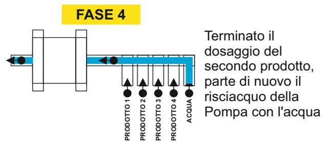
in questo modo la pompa è pulita ad ogni dosaggio e **NON SI USURA.**
