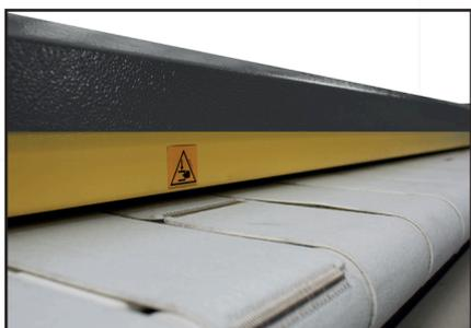
**FINESTRE DI PROTEZIONE:** nella calandra con **piegatrice** le finestre di protezione al di sotto del tavolo di introduzione permettono di controllare senza alcun rischio la correttezza delle operazioni di piega o verificare eventuali capi incastrati.
